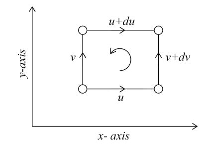
$\Gamma = (u)dx + (v + dv)dy - (u + du)dx - (v)dy$
